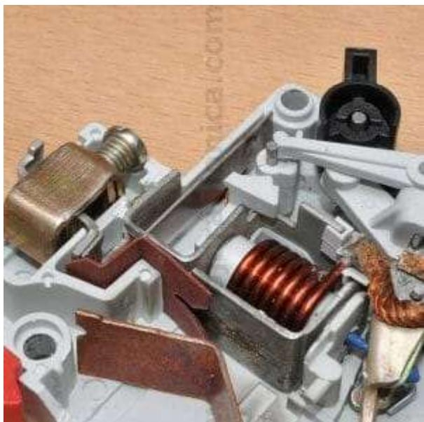
Protiv struje preopterećenja zadužena je bimetalna traka. Ukoliko se nazivna struja poveća malo iznad nazivne struje (struja koja redovno protiče kroz automatski osigurač i za koju je projektovana instalacija) to će dovesti do zagrevanja bimetalne trake i do njenog krivljenja u jednu stranu. Ovo deformisanje bimetalne trake će pokrenuti polužni sistem sa oprugom koji će isključiti automatski osigurač.
