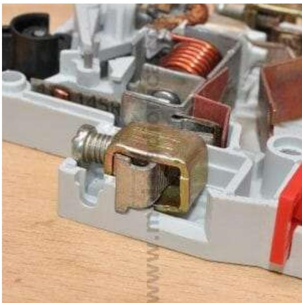
Automatski osigurač raspolaže sa dve priključne stezaljke, dovodnom i odvodnom. U dovodnu stezaljku se postavlja fazni provodnik od strane mreže, obično preseka do 25 mm kvadratnih. Po pravilu u razvodnoj tabli, dovodne stezaljke osigurača jedne grupe se kratko spajaju. U odvodnu stezaljku se pričvišćuje fazni povodnik koji ide prema potrošaču, preseka do 6 mm kvadratnih.
